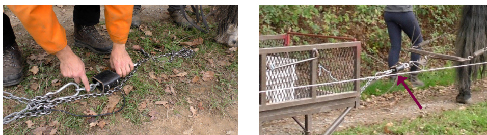
Figure 3 / Positionnement de la centrale d'acquisition pendant le test standardisé © P. Bouvier
