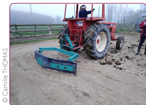
Figure 6 / Tracteur équipé d'un rabout permettant le raclage des crottins sur l'aire en sable
